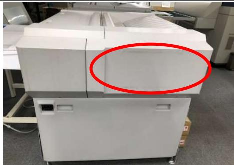
電導度センサーは、版の挿入口から見て左側のカバーの中にあります。
