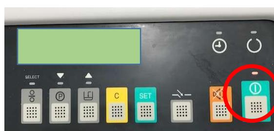
初期化動作が完了したら、運転キーを押します。
