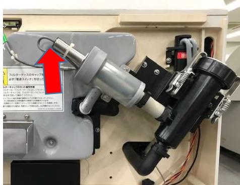
センサーチューブの根元を見てください。ケーブルの被覆が破れて電線が剥き出しになっている場合は、部品交換が必要です。コールセンターへ連絡して頂き、障害内容は『E620-B』とお伝えください。
