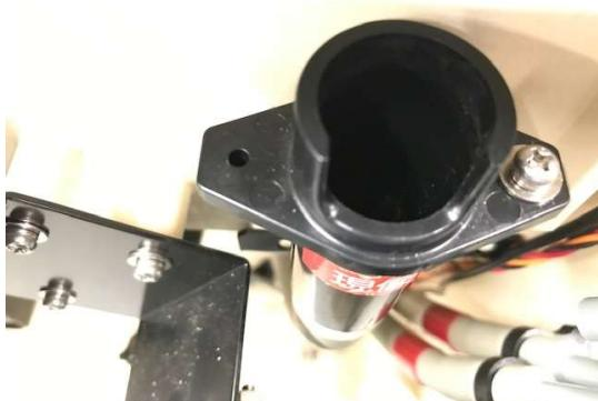
ノズルが掛かっていた筒の中も確認してください。筒の中に白い塊が有った場合は、細い棒などで、塊を崩して除去します。
