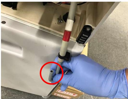
ノズルの口に異物が詰まっていたら、細い棒などで除去します。
