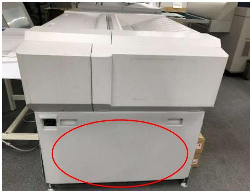
起動中に、機械の下の方（写真の赤丸付近）から、タカタと音が鳴っているか、確認します。
